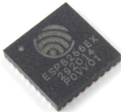
Рисунок 3.4 – Микроконтроллер ESP8266
