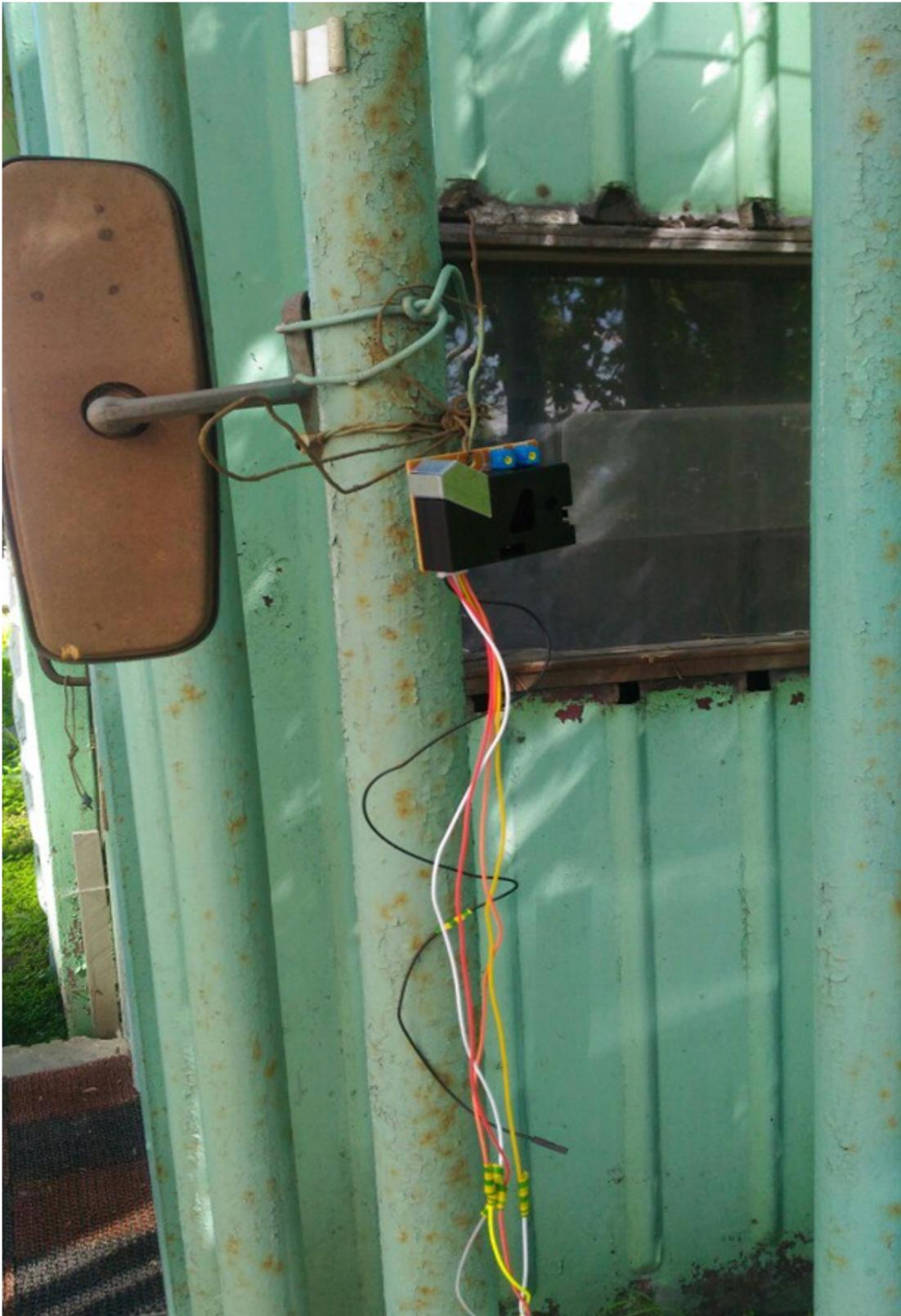
Рисунок 4.2 – Общий вид расположения датчика DSM-501A
