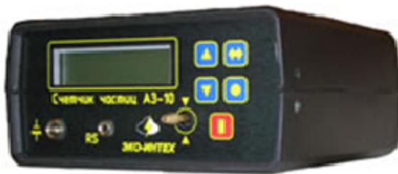
Рисунок 2.5 – Внешний вид счетчика аэрозольных частиц А3-10 [17]
