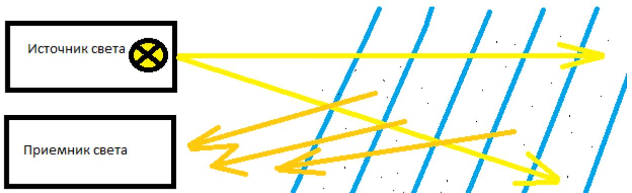
Рисунок 2.2 — Простейшая схема трансмиссометра
